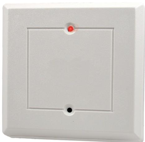
A série de detectores DS1102i usa a tecnologia de análise de som por microprocessador (SAT) para captar as frequências específicas associadas à quebra de vidros. Os detectores DS1102i e DS1102i-CHI podem ser usados para detectar a quebra de vidros planos, temperados, laminados e aramados. Possui uma funcionalidade incorporada de teste ambiental, que avisa o instalador relativamente a perigos de falso alarme em ambientes adversos. Os detectores quadrados são montados nos tectos ou nas paredes.
