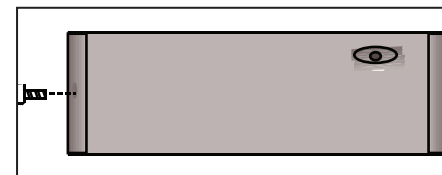
Рис. 6.1. Установка винта-контакта несанкционированного вскрытия устройства
