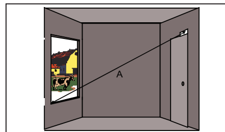
Рис. 3.1. Установка на противоположную стену с использованием дверного контакта
