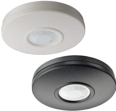
Der DS936 PIR Deckenmelder verwendet die Impulszählung mit wechselnder Polarität. Eine Fresnel-Linse bietet einen Überwachungsbereich von 7,5 m. Der Melder ist für die Aufputzmontage geeignet, kann aber auch halb eingelassen in die Decke oder in eine 8-Kant-Standarddose montiert werden.
