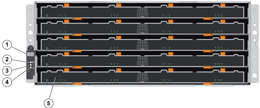
60-wnękowy moduł z dwoma sterownikami lub moduł rozszerzenia – widok z przodu
