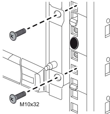
6. 後側滑軌柱腳：插入螺絲穿過裝置、機架或系統機櫃及滑軌前側的孔洞，將裝置固定在機架或系統機櫃後側及滑軌上。
