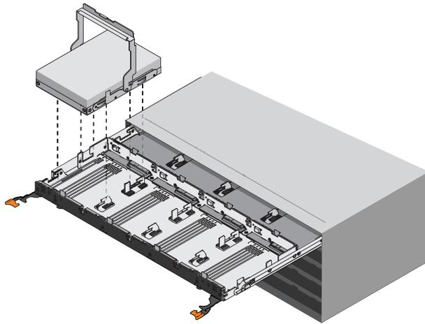
4. 從前面最左側的插槽開始，將磁碟機的兩個凸出按鈕與抽取匣上的凹口對齊。然後輕壓磁碟機頂部，並將磁碟機的把手向下轉，直到磁碟機卡入定位。
