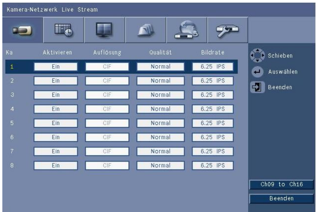
Bild 6.8 Kamera – Network Live Streaming Gehen Sie wie bei der fortlaufenden Aufzeichnung vor, und stellen Sie die Werte für Kameras ein, deren Bilder per Streaming über das Netzwerk gesendet werden. – Netzwerk-Streams werden nicht aufgezeichnet.
