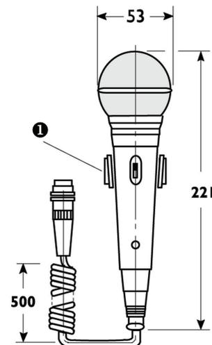
Abmessungen mit Wandhalterung (1) in mm
