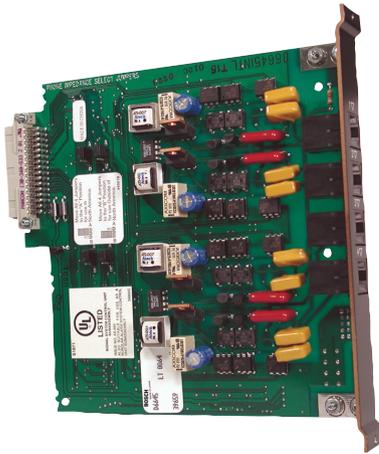
Modulare Steckplatine. Bietet Isolierung und Überspannungsschutz für D6641 Conettix Telefonnetz-Empfangsmodule. Ist ausgestattet mit vier RJ11-Modularbuchsen zum Anschließen von Telefonleitungen.
