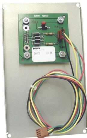
Erweitert den D6600 Conettix Leitstellenempfänger um eine dritte serielle Schnittstelle. Verfügt über einen DB9-Stecker und Überspannungsschutz.
