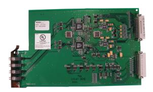
Tarjeta de líneas con tecnología de procesador digital de señales (DSP). Responde y descodifica las señales de hasta cuatro líneas telefónicas de forma simultánea. El receptor/pasarela de comunicaciones Conettix D6600 aceptará hasta ocho tarjetas de líneas telefónicas para crear un total de 32 líneas telefónicas. Requiere una tarjeta de terminador de líneas telefónicas Conettix D6645.
