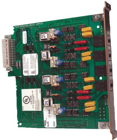
Tarjeta de circuitos conectable de diseño modular. Proporciona aislamiento y supresión de oscilaciones para la tarjeta de líneas telefónicas Conettix D6641. Proporciona cuatro conectores RJ11 modulares para las conexiones de las líneas telefónicas.
