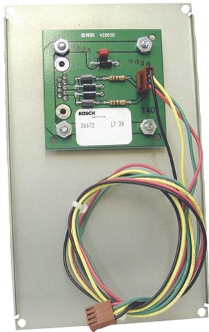
Crea un tercer puerto serie en el receptor/pasarela de comunicaciones Conettix D6600. Proporciona un conector macho DB9 y protección contra oscilaciones.
