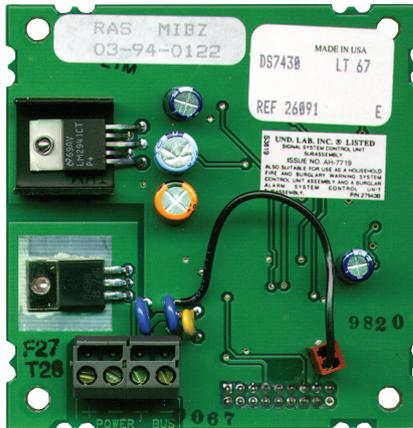
DS7430 è un modulo di espansione multiplex da utilizzare con le centrali di controllo serie DS7400Xi. Si collega direttamente alla centrale di controllo e fornisce un bus multiplex a due conduttori per la connessione a un massimo di 120 sensori e/o moduli multiplex.
