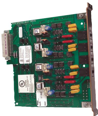
Scheda dei circuiti per plug-in modulari Consente l'isolamento e la soppressione transitoria della scheda di linea telefonica Conettix D6641. Fornisce quattro prese modulari RJ11 per collegamenti di linee telefoniche.
