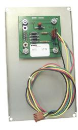
Consente di creare una terza porta seriale sul gateway/ ricevitore di comunicazioni Conettix D6600 Fornisce un connettore DB9 maschio ed una protezione transitoria.
