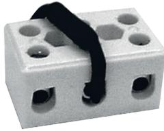
LBC 1256/00 은 EVAC 연결 어댑터로 라우드스피커 장치의 100V 1 차 연결부에 직렬로 연결하면 라우드스피커가 BS 5839-8 와 호환되는 장치로 바뀝니다. 따라서 이 연결 어댑터를 추가로 사용하면 화재시 라우드스피커가 손상되더라도 스피커와 연결된 회로에 장애가 발생하지 않으며 이러한 식으로 시스템의 무결성이 유지됩니다. 이 연결 어댑터는 온도 퓨즈가 사전 장착된 3 극 세라믹 스크루 터미널 블록으로 구성되어 있습니다. 이 어댑터는 연결 터미널을 대체할 수도 있으며 표준형 연결함에 장착될 수도 있습니다. LBC 1256/00 은 100 개 1 세트 구성되어 있습니다.
