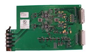
Placa de linha com tecnologia de processador de sinal digital (DSP). Responde e descodifica sinais provenientes de um máximo de quatro linhas telefónicas em simultâneo. O receptor/gateway de comunicações Conettix D6600 aceita até oito placas de linha telefónica para criar um total de 32 linhas telefónicas. Necessita de uma placa terminadora de linha telefónica Connetix D6645.
