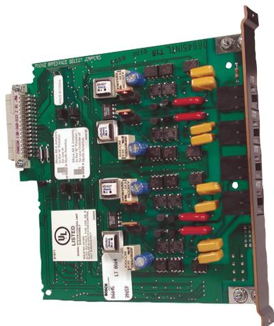
Placa conectora de circuito impresso e concepção modular. Proporciona isolamento e supressão de transitórios à placa de linha telefónica Conettix D6641. Proporciona quatro tomadas modulares RJ11 para ligações de linha telefónica.
