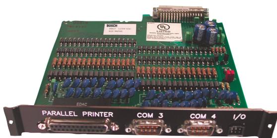
Placa conectora de circuito impresso e concepção modular. Proporciona uma interface blindada entre a placa de linha de CPU Conettix D6610 e as ligações externas aos computadores e impressoras de bases de dados de automação. Inclui:
