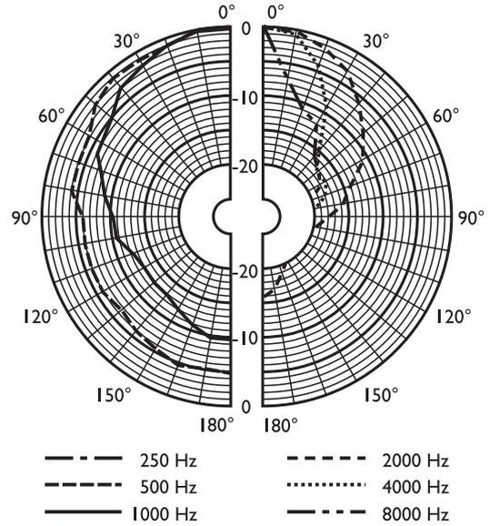
垂直指向性图 (使用粉红噪声测量)
