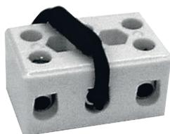
LBC 1256/00 是一种 EVAC 连接适配器，可以与扬声器装置的 100 V 主连接线路进行串联，从而使扬声器成为符合 BS 5839-8 标准的装置。这一附加的连接适配器可以确保在发生火灾时对扬声器造成的破坏不会导致与其连接的电路发生故障。这样，系统的完整性得以维持。连接适配器包含一个 3 极陶瓷螺丝接线盒，并且预安装有温度保险丝。它可以替代接线端子或安装在标准接线盒中。LBC 1256/00 的数量为 100 个。
