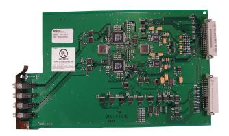
采用数字信号处理器 (DSP) 技术的线路卡。 对最多来自四条电话线的信号同时进行应答和解码。 Conettix D6600 通信接收器/网关最多可容纳八个电话线路卡,总共可容纳 32 根电话线。 需要一块 Connetix D6645 电话线终结卡。
