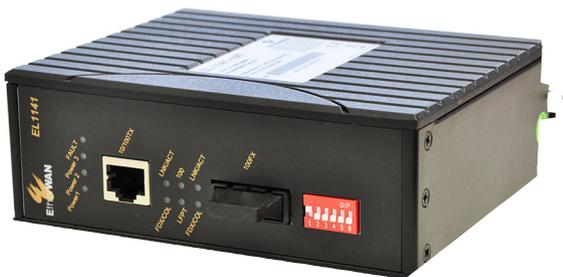
Il convertitore in fibra ottica Ethernet viene utilizzato per l'automazione dell'utilità elettrica e accetta Full/Half duplex da 10/100 Mbps, la negoziazione automatica, MDI/MDIX automatico. Il convertitore è conforme allo standard di IEC61850-3, IEEE1613 ed EN50121-4.
