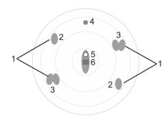
由日光和商业光源产生的干扰效应将被光学日光过滤器及通过使用电子过滤和锁相调整加以滤除(环境光线稳定性: 眩光试验 DIN EN 54-7)。
