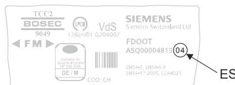
Abb. 2: Beispiel eines Produktlabels mit Angabe des Erzeugnisstands
