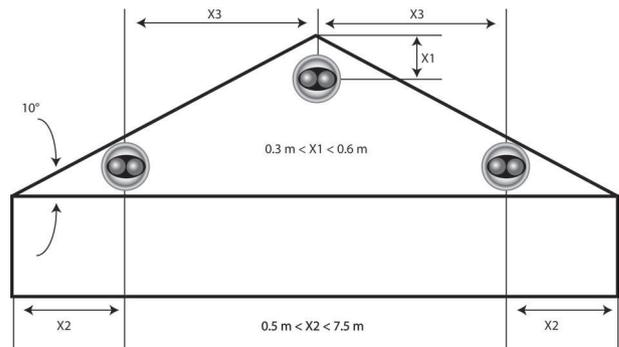
Fig. 4: Montage (toit à double pente)
