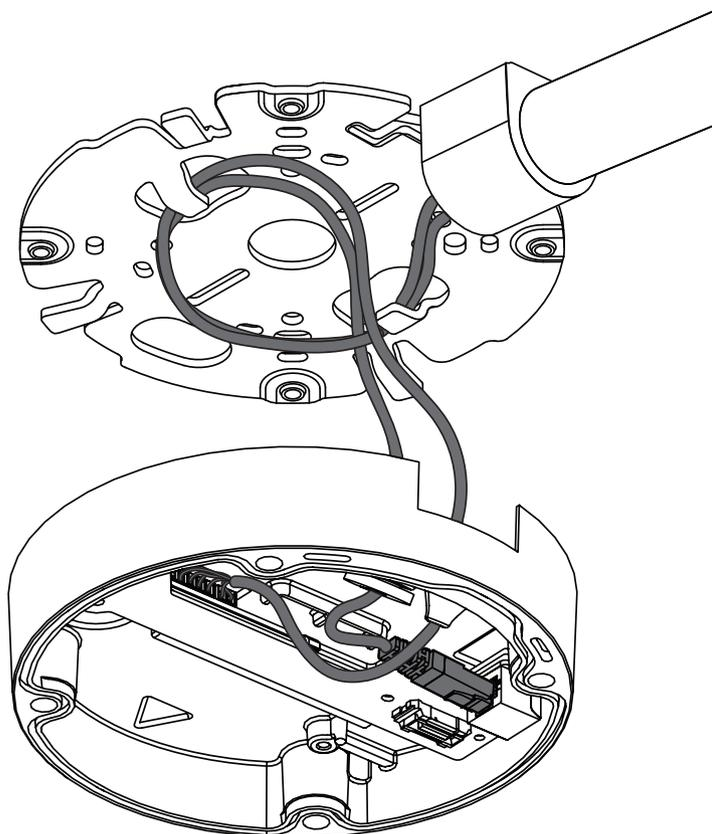
9. Прижмите основание камеры к монтажной пластине и поверните основание по часовой стрелке, пока не услышите или не почувствуете щелчок. Убедитесь, что основание камеры надежно зафиксировано.
