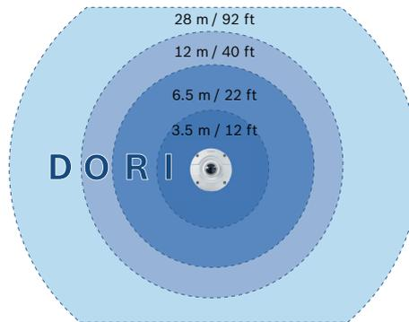
Se montata all'altezza di 3 m, la versione 360° della telecamera fornisce il seguente raggio di copertura per i quattro livelli:
