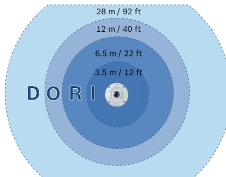
Quando montada a uma altura de 3 m, a versão de 360° da câmara tem o seguinte raio de cobertura para os quatro níveis:
