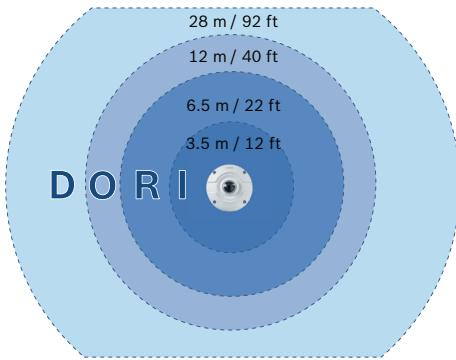
При установке на высоте 3 м версия камеры с объективом 360° имеет следующий радиус покрытия на четырех уровнях:
