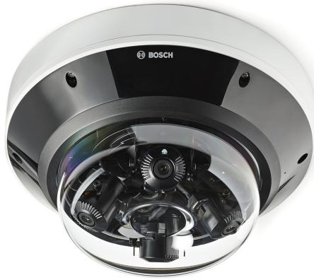
FLEXIDOME multi 7000i IR摄像机专为出色性能表现而打造，它具有四个配备电动变焦/对焦镜头的独立成像仪。它有助于简化安装和降低成本，同时还能灵活调整覆盖区域。一台摄像机可同时拍摄四个场景，因此非常适合大区域覆盖、交叉路口和建筑物角落。凭借其集成的360°红外照明，该摄像机可在极低照度条件下（如夜间或黄昏）拍摄到清晰的图像。将镜头倾斜到适当的角度时，摄像机甚至可覆盖整个360度的范围。此外，变焦功能使摄像机可为距离更远的场景拍摄精细画面。
