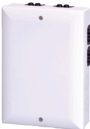
Der FLM-420-RLV8-S Octo-Relaiskoppler für Kleinspannung verfügt über acht Wechselkontakt-Relais zur Bereitstellung von potentialfreien Ausgangskontakten. Der Koppler ist ein 2-Draht-LSN-Element. Bei Anschaltung an die Brandmeldezentralen FPA-5000 und FPA-1200 bietet der Koppler die erweiterte Funktionalität der LSN-improved-Technologie.
