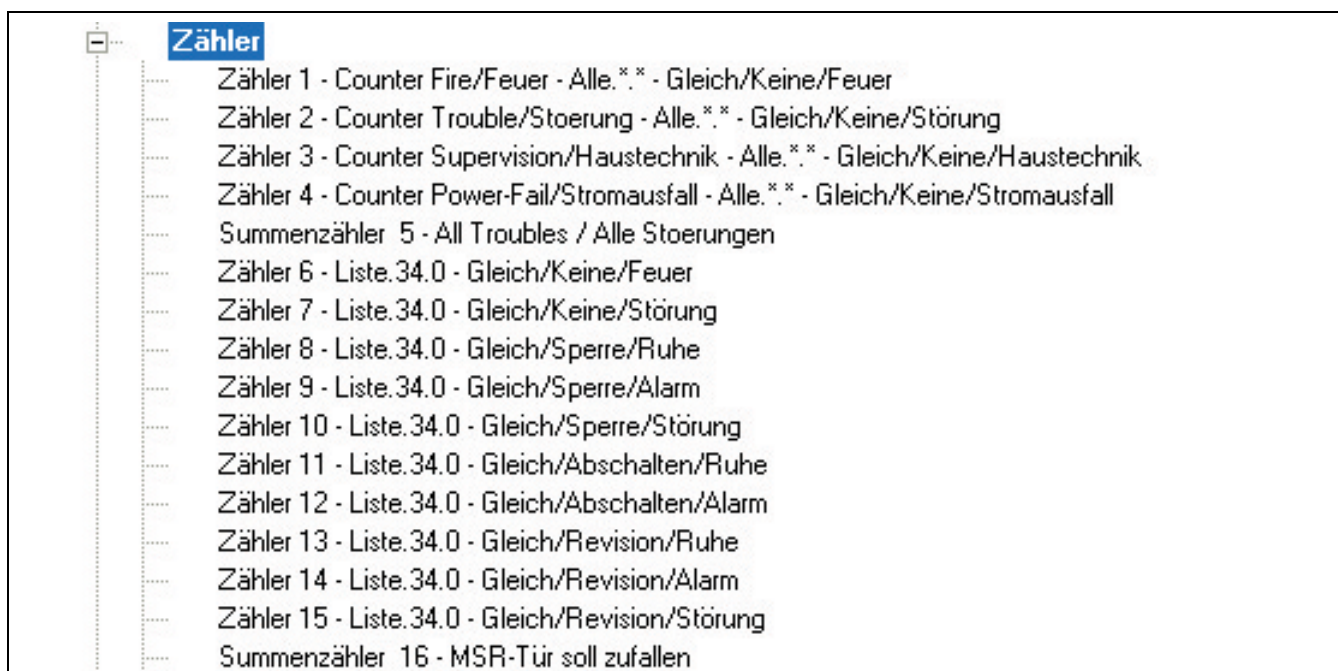
Bild 2.3 Auslösekriterien für FAA-420-MSR bzw. FSA
