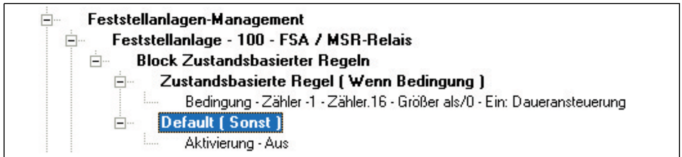
Bild 2.4 Summenzähler 16 im Feststellanlagen-Management
