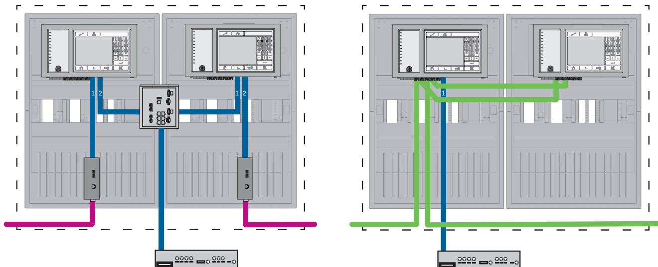
Rysunek 7.9: Po lewej stronie: sieć Ethernet; po prawej stronie : sieć CAN
