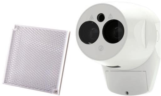
Le FRAY-ONE-EN est un détecteur de faisceau linéaire facile à monter et économique. Il couvre des distances comprises entre 5 m et 120 m. Un prisme réfléchissant permet une détection précise des particules de fumée dans la plage de distance donnée. Pour les portées comprises entre 5 et 50 m, un seul prisme suffit. Pour des portées comprises entre 50 m et 120 m, quatre prismes sont nécessaires. Les prismes supplémentaires sont inclus dans le FRAY5000-LR-KIT.
