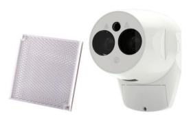
O FRAY-ONE-EN é um detector de feixe linear fácil de montar e eficiente do ponto de vista econômico. Cobre distâncias entre 5 m e 120 m. Um prisma refletivo permite a detecção precisa de partículas de fumaça dentro de uma determinada faixa de distância. Para distâncias entre 5 m e 50 m, um prisma é suficiente. Para distância entre 50 m e 120 m, quatro prismas são necessários. Os prismas adicionais estão inclusos no FRAY5000-LR-KIT.
