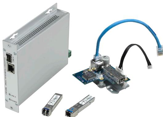
博世光纤介质转换器系列可以使用10/100 Mbps小型可插拔(SFP)模块通过光纤传输10/100 Mbps以太网信号。这些光纤介质转换器设备可用于传输远远超过100米铜基介质极限的以太网数据，并提供无EMI/RFI的安全传输路径。
