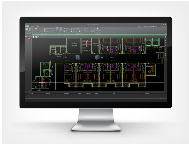
Sustav nadzora za dojavu požara grafičko je korisničko sučelje za prikaz i nadzor malih i srednjih sustava protupožarnih alarma s najviše 10000 točaka detekcije. Kompatibilno s uređajima AVENAR panel 8000, AVENAR panel 2000, FPA-5000 i FPA-1200.
