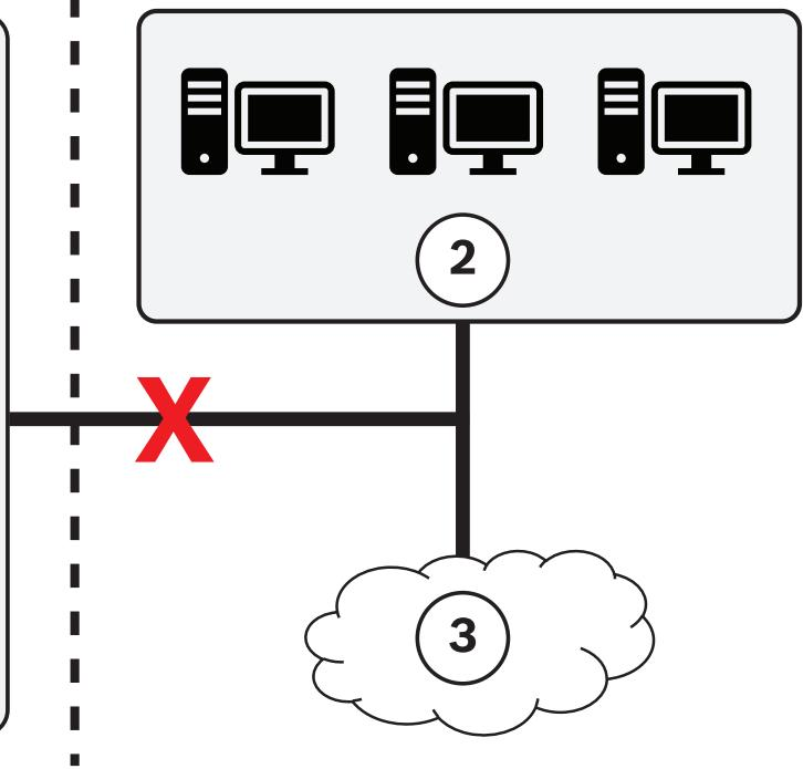
okruženja. Sustav nadzora za dojavu požara mora biti dio posebne Ethernet mreže protupožarnog alarma bez izravnog pristupa internetu (3).
