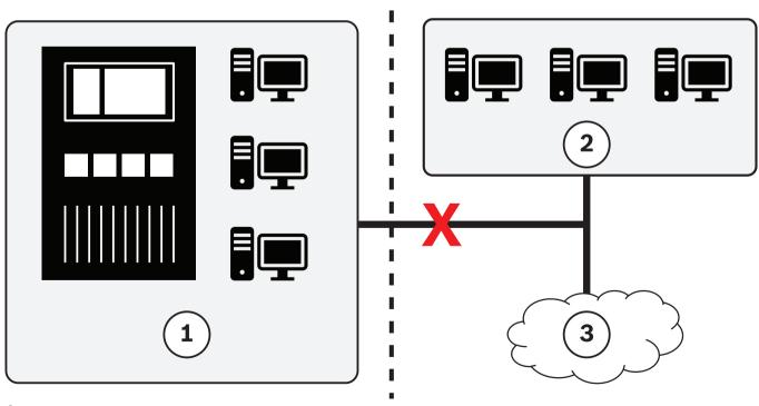
É necessária uma rede Ethernet exclusiva para configurar uma rede de painéis de alarme de incêndio (1). Por motivos de segurança e confiabilidade, nenhuma rede usada para qualquer
