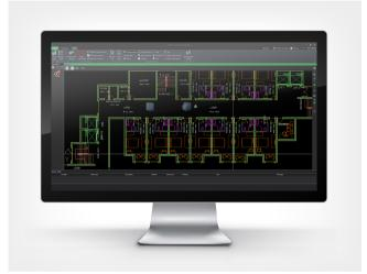
O Sistema de monitoramento de incêndios é uma interface gráfica com o usuário para apresentação e monitoração de pequenos e médios sistemas de alarme de incêndio com até 10000 pontos de detecção. É compatível com AVENAR panel 8000, AVENAR panel 2000, FPA-5000 e FPA-1200.
