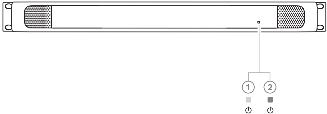
Figura 6.6: Descrição do painel frontal do OMN-DANTEGTW
