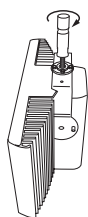
図 5.5: フロアスタンド用スタッドのラジエータ用天吊りブラケットへの取り付け
