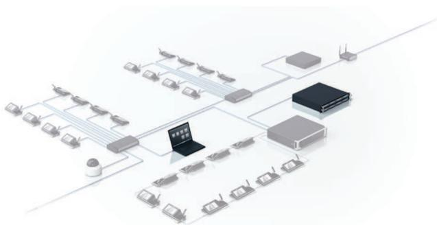
L'émetteur INT-L1AL vous permet d'ajouter un canal de langue unique à l'émetteur OMNEO INT-TXO, avec possibilité de transmission infrarouge. Vous pouvez activer jusqu'à 28 canaux de langues supplémentaires pour un total de 31 langues d'interprétation, hormis la langue de l'orateur.
