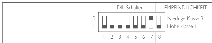
Abbildung 10. DIL-Schalter bei abgenommener Frontabdeckung des Melders (normale Werkseinstellungen abgebildet)
