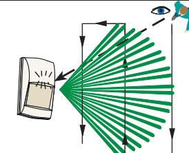
Zapněte napájení detektoru. Počkejte alespoň 2 minuty. Doba trvání poplachu je 4 sekundy. **Poznámka:** Nechte detektor zkontrolovat alespoň jednou
