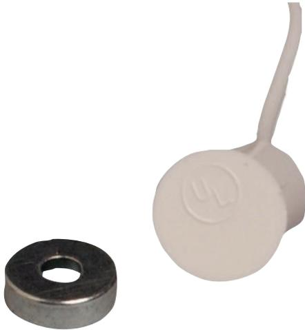
Die Einbaumagnetkontakte sind mit Hauptanschlüssen versehen. Sie weisen eine Miniaturbauform auf, die kürzer als die der Kompaktkontakte ist. Sie enthalten einen starken, dünnen Magneten. Konkaves Loch im Magnet gewährleistet bündigen Sitz von Flachkopfschrauben. Die Magnetkontakte können für Fensterrahmen, dünne Türrahmen oder Sicherheitsgitter eingesetzt werden.
