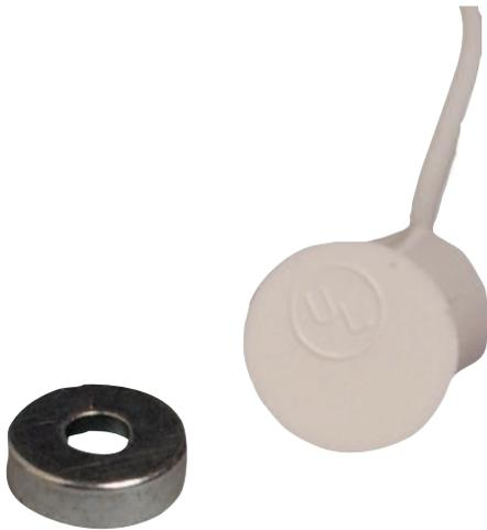
Los contactos magnéticos para empotrar tienen conexiones para cable. Presentan un auténtico diseño en miniatura y son más cortos que los contactos de diseño compacto. Incluyen un imán potente y delgado. Este imán dispone de un orificio convexo que permite empotrar tornillos de cabeza plana. Los contactos magnéticos se pueden utilizar en marcos de ventanas, marcos de puertas estrechos o pantallas de seguridad. Los contactos están disponibles en marrón o en blanco.
