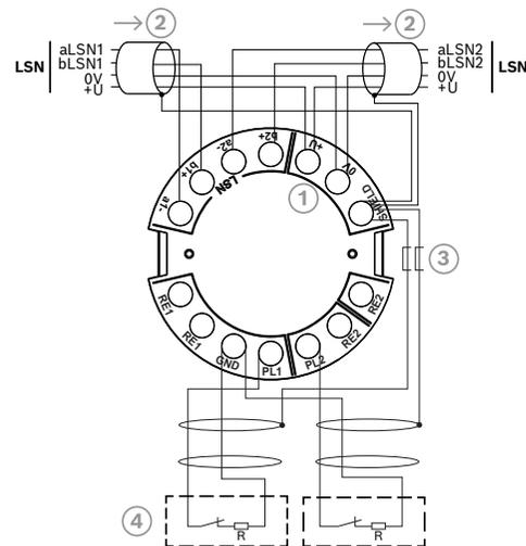
Fig. 3: Connexion à 2 fils
