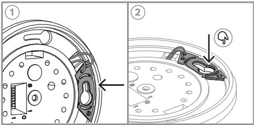
Fig. 5: Verrouillage du contact d'autosurveillance mural
