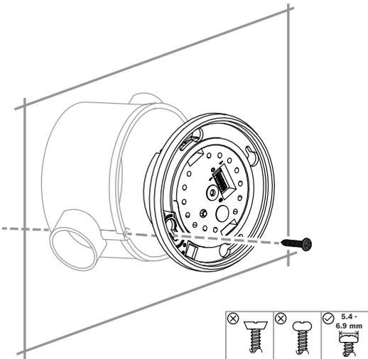
Fig. 6: Fixation du contact d'autosurveillance mural
