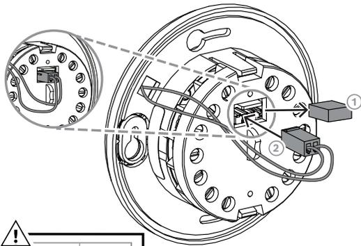
Fig. 4: Collegamento del contatto anti-manomissione da parete
