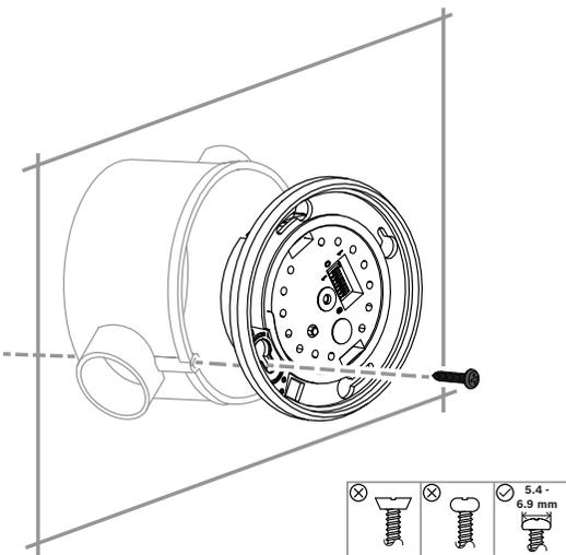
Fig. 6: Fissaggio del contatto anti-manomissione da parete
