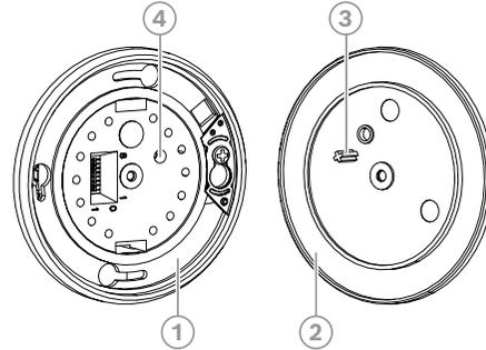
Fig. 7: Chiusura del modulo di espansione
