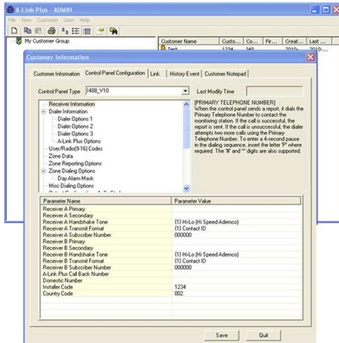
ITS-ALINK-PLUS es el software de programación remota para paneles de control compatibles. Ofrece una interfaz flexible y fácil de usar entre un PC y los paneles de control. El software permite programar los paneles de control de forma remota a través de un módem o directamente desde el PC mediante el cable de conexión directa.
