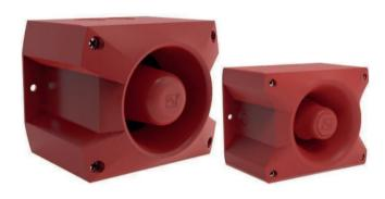
Промышленные звуковые оповещатели РА 5 и РА 10-SSM представляют собой акустические устройства универсального назначения для применения в системах пожарной и охранной сигнализации. Они имеют степень защиты IP 66, работают от 24 В пост. тока и соответствуют стандарту EN 54-3.
